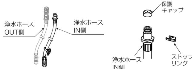
2. 給水バルブを手で持ち、浄水ホースIN側を給水バルブのソケット部に差し込み、ストッピングリングで固定する。
