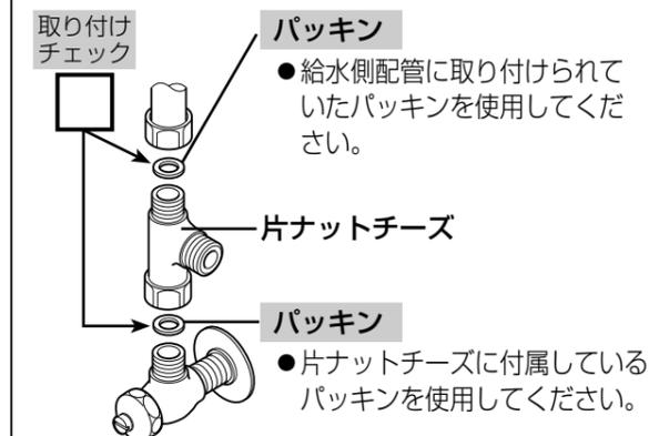
分岐チーズ、片ナットチーズ (6ページ) に止水栓を取り付ける
